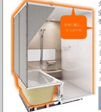
タカラシステムバスは、浴室全体を包み込む発想で保温材を使用した、トータル保温。天井裏・壁パネルの内部・浴槽裏・床には標準装備で発泡ウレタンをいれております。あたたまった浴室の熱を逃さず冬場の入浴もとても快適です。
