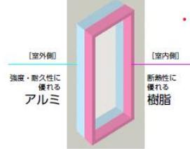
室外側に強度・耐久性に優れたアルミを採用し、雨、風、日差しによる劣化を防止。室内側には断熱性に優れた樹脂を採用し、熱の出入りを抑制。アルミの良さと樹脂の良さを融合させた新しい構造の窓、それが「ハイブリッド窓」です。
