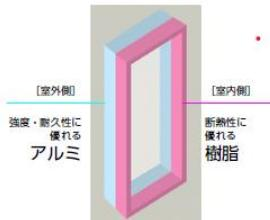
室外側に強度・耐久性に優れたアルミを採用し、雨、風、日差しによる劣化を防止。室内側には断熱性に優れた樹脂を採用し、熱の出入りを抑制。アルミの良さと樹脂の良さを融合させた新しい構造の窓、それが「ハイブリッド窓」です。
